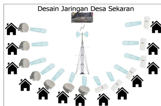
Gambar 5. Topologi Point to Multipoint jaringan desa Sekaran
